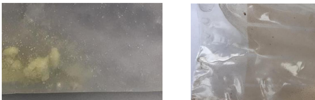
Abbildung 72: links: weißer Film auf PE-Folie. Rechts: Verklebte PE-Folie mit öliger Flüssigkeit.
