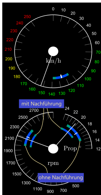
Abbildung 5.35.: Cockpitdisplay für das steilste Steigen ohne und mit Nachführung der Antriebsparameter.
