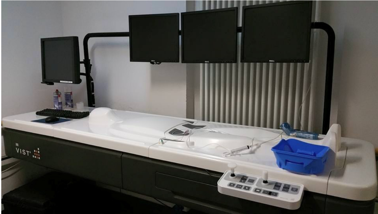
Abb.3: VR- Simulator Mentice VIST®-Lab. Stationäre Einheit mit Patientenmodell, Kontrollbildschirm und weiteren Monitoren. Die Fußpedale sind auf dieser Abbildung nicht dargestellt. Die Einheit befand sich für die Dauer der Untersuchungen in einem separaten Raum im Neuro-Kopf-Zentrum des Klinikums rechts der Isar, Technische Universität München.
