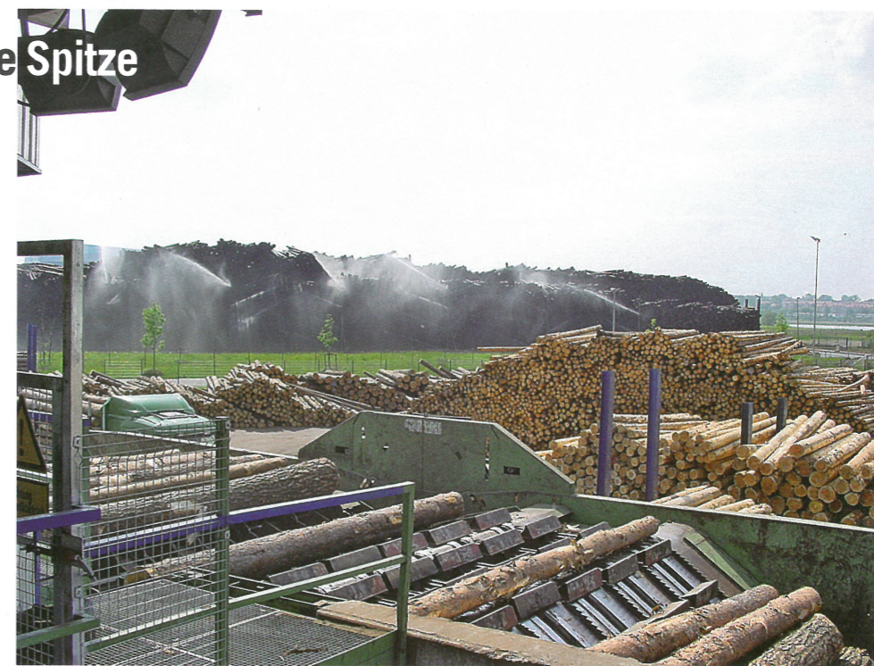
Puffer für kalte Winter: 70 000 Fm Rundholz befinden sich derzeit im Nasslager hinter Rundholzaufgabe (vorn) sowie sortierten und entrindeten Abschnitten.
