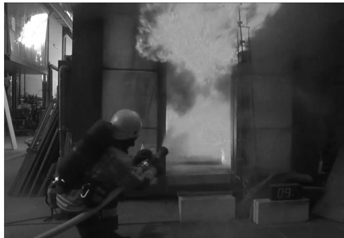
Bild 6 Löschmaßnahmen durch eine Berufsfeuerwehr mit einem Hohlstrahlrohr
