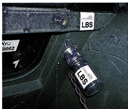
Der Geräteidentifizierer informiert das Bordterminal über die angeschlossene Maschine.
