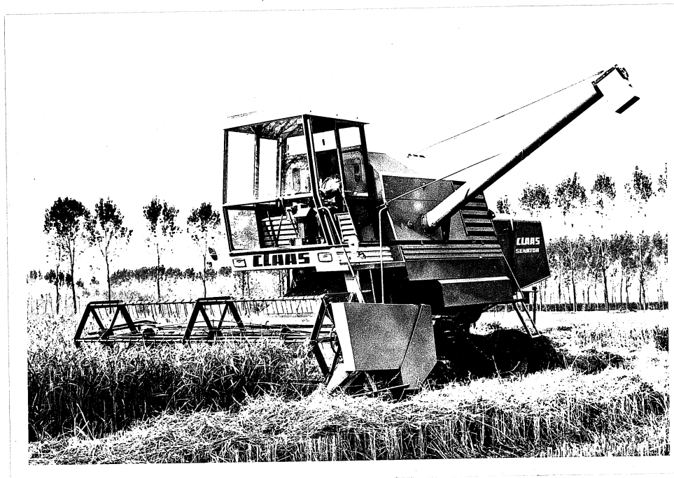
Abb. 35: Westdeutscher, selbstfahrender Mähdrescher mit Fahrererkabine (Claas), der unter dem Namen "Ford" seit 1966 in die USA eingeführt wird.
