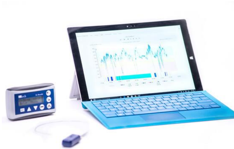
Abbildung 1 Dx-pH System zur oropharyngealen pH-Messung [220]
