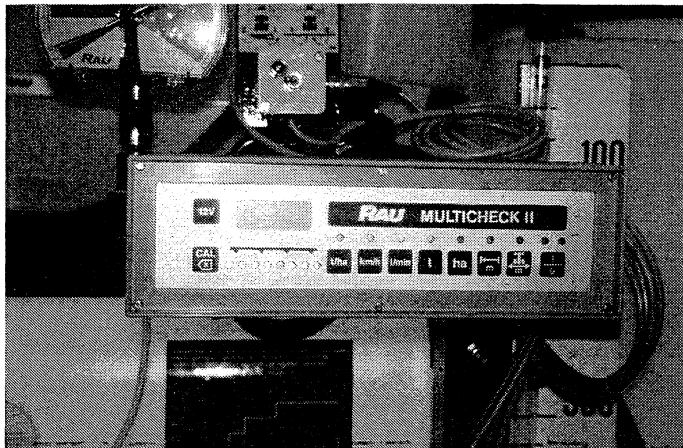
AUCH DER SPRITZENMONITOR braucht die Signalsteckdose, denn ohne Wegmessung keine Ausbringdaten. Fotos: Auernhammer
