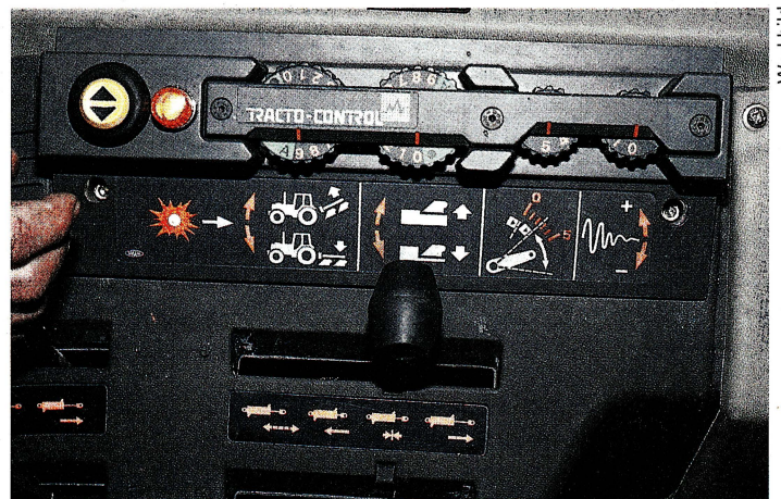
Elektrohydraulische Hubwerksregelungen lassen sich nachträglich mit einer Schlupfregelung versehen.
