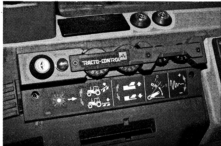
▲ In schweren Schleppern ist bei umfangreichen Zugarbeiten die EHR vorteilhaft. (2)
