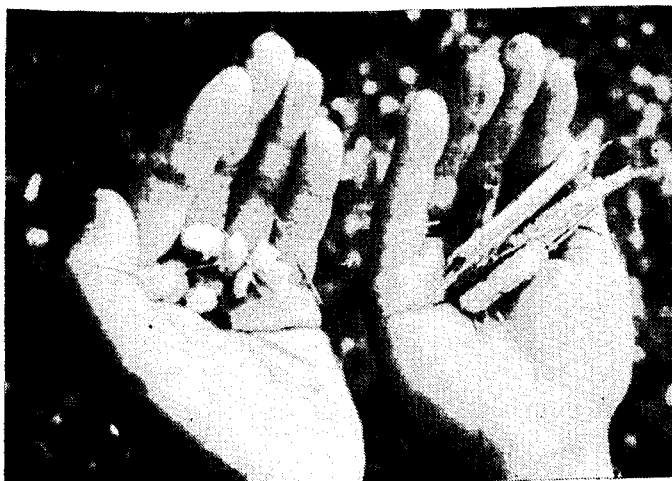
Abb. 6: Beeinflussung der Häcksellänge durch die Vorfahrt (Topinambur). Links: ca. 5 mm, vf \sim 0,3 m/s; rechts: 25 — 40 mm, vf \sim 1,5 m/s
