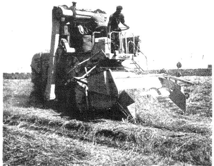
wie durch Einbau von Hochleistungs-sieben und Arbeiten mit scharfen Windströmen konnte jedoch erreicht werden, dass die heutigen Mäh-drescher bei Hangneigungen bis zu 20 % nur einen geringen Leistungsverlust aufweisen. Besondere Trennstage auf den Sieben sollen die Störungen in Schräglagen weiterhin vermindern. Für noch grössere Hangneigungen wurden in letzter Zeit selbsttätige hydraulische Hangverstellungen der Räder entwickelt, die technisch sehr beachtliche Lösungen darstellen.
