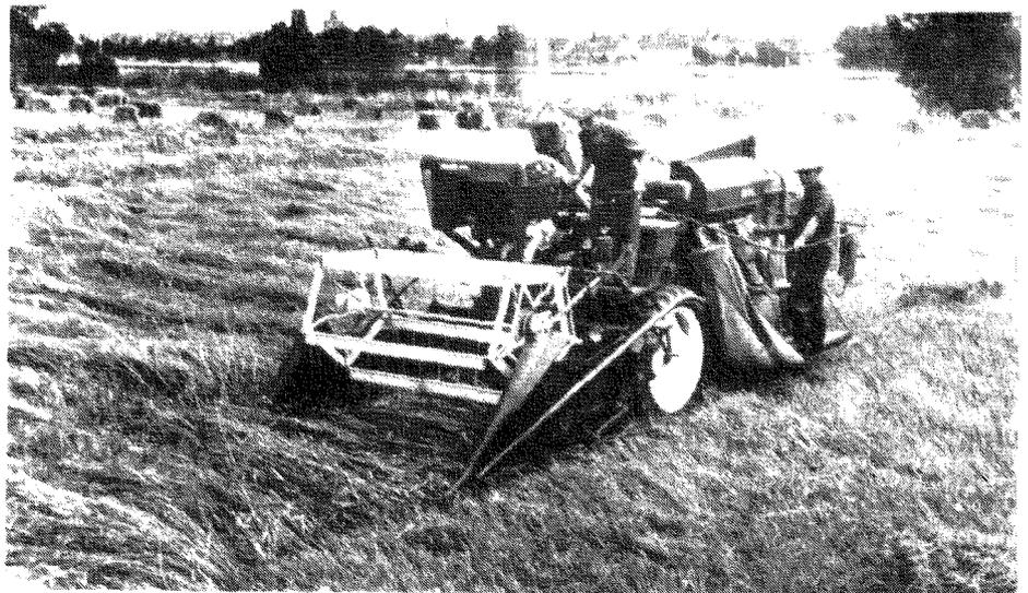
14) Selbstfahrer-Mähdröschler, Typ MDL, mit 2,10 m Arbeitsbreite beim Aehren von stark liegendem Getreide (Maschinenfabrik Fahr AG., Gollmadsheim, Kr. Konstanz)
