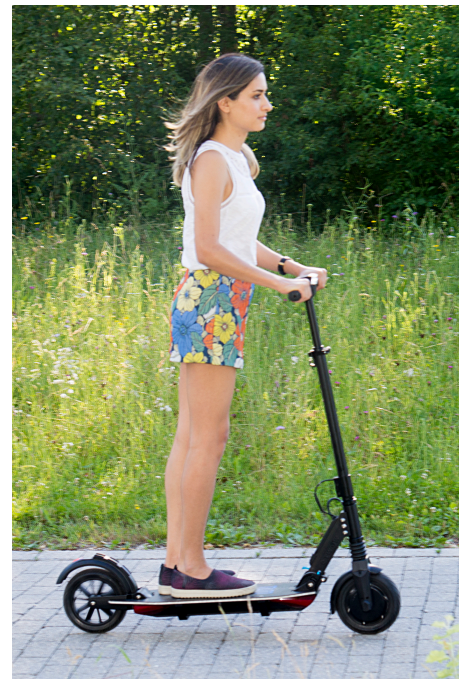
eScooter mit Trittbrett aus Granit und Algen-Carbonfasern
