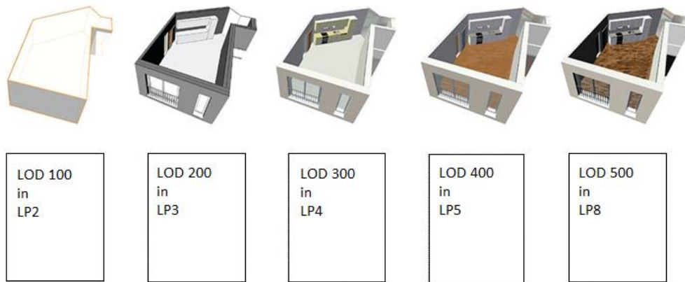
Abbildung 11: Zuordnung der LOD zu Leistungsphase (Computerworks 2019)
