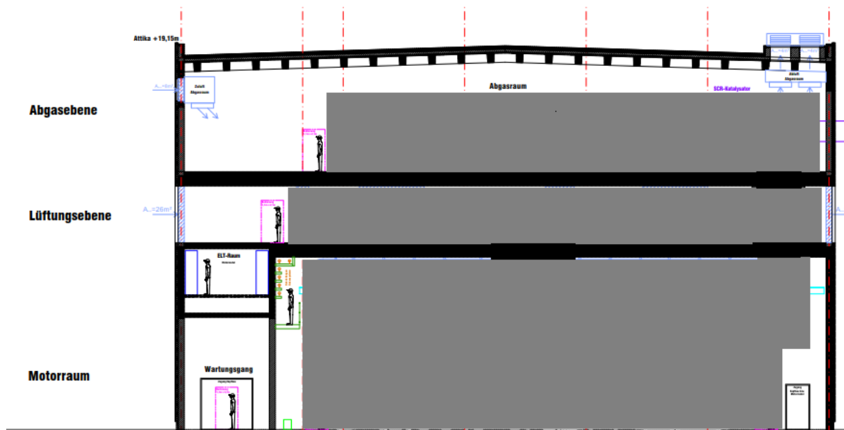
Abbildung 13: Beispiel Aufbau einer Motorzelle mit Lüftungsebene
