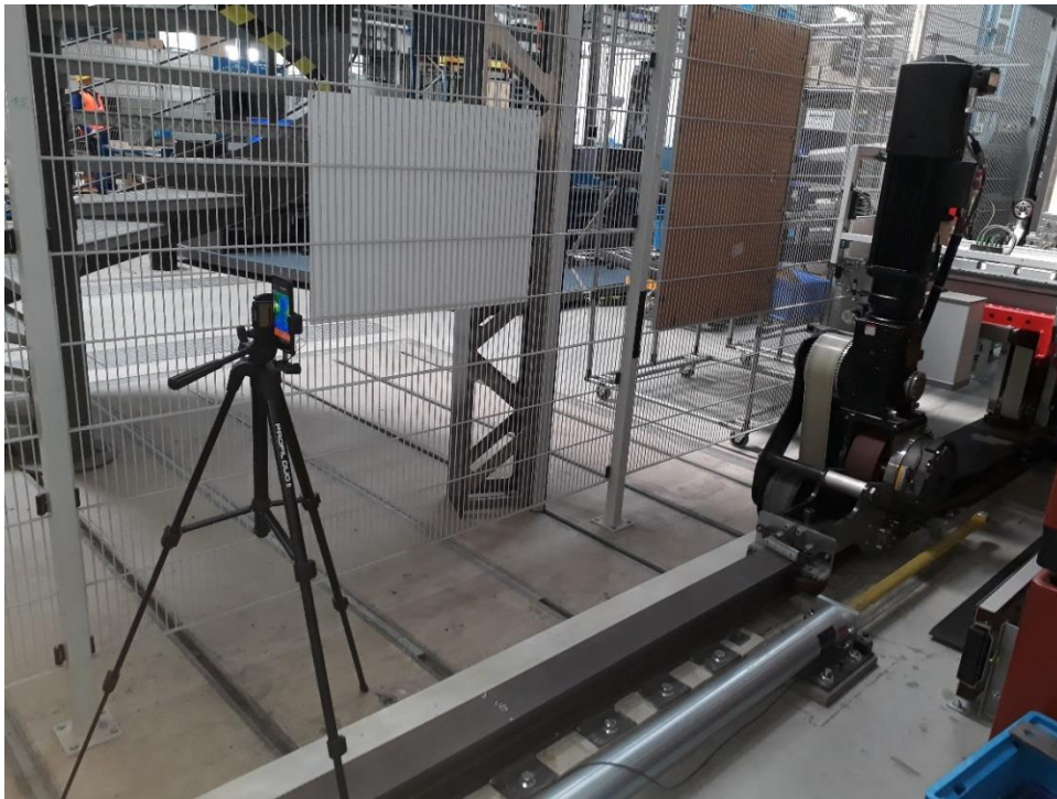
Abbildung 3-5: Versuchsaufbau zur Untersuchung des Fahrtriebs [Pre-2018, S. 37]
