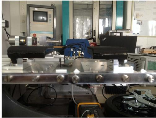
**Abbildung A.2:** Montage der Träger und der Befestigungsplatten.
