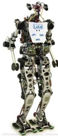
**Abbildung 1.1:** Der humanoide Laufroboter LOLA des Lehrstuhl für Angewandte Mechanik [40]
