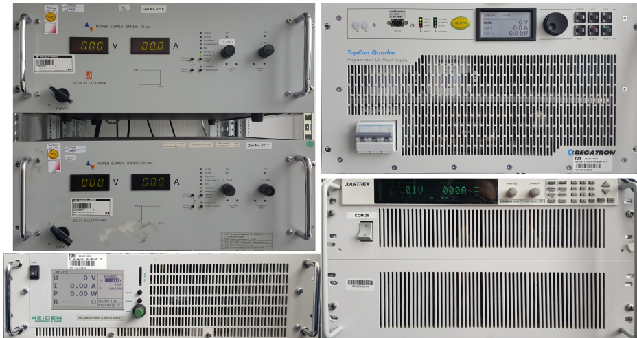
Abbildung 3.6. – DC-Quellen zur Ansteuerung der Wechselrichter
