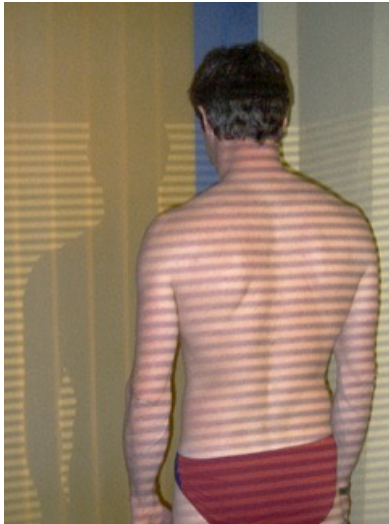
Abbildung 3-3: Linienprojektion, Beleuchtung des Rückens mit hellen und dunklen Streifen
