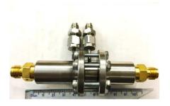
Fig. I.5. Venturi flow meter
