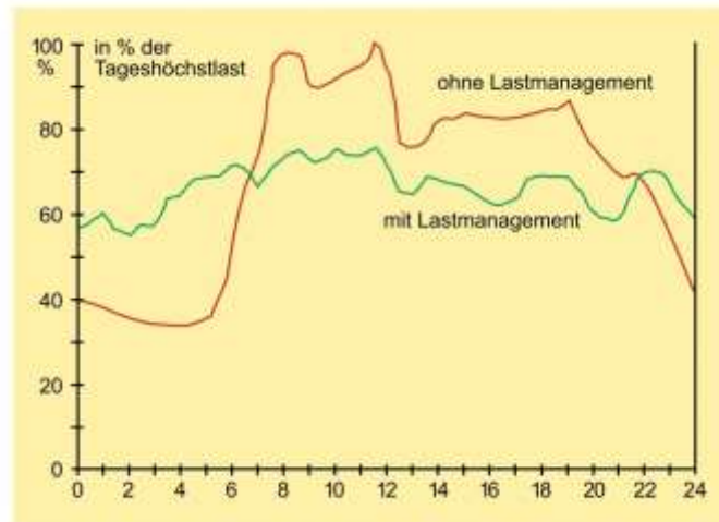
Abbildung 2-18: Lastlinien mit und ohne Lastmanagement [Sch-2009, S. 724]
