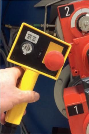
Bild 2: Handgerät zur Ansteuerung der Antriebe.
