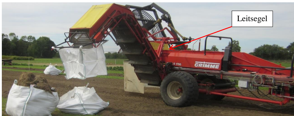
Abbildung 31: Trägerfahrzeug mit Leitsegel und Querelevator zum Befüllen von Probenbehältnissen
