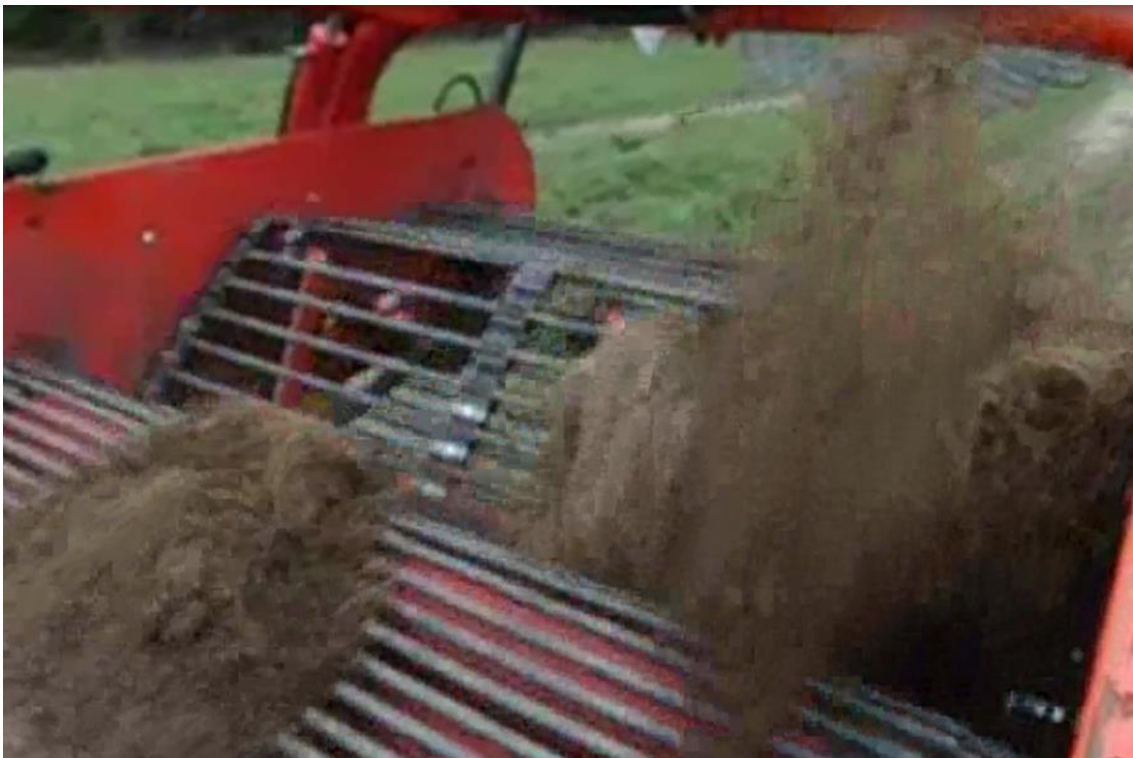
Abbildung 73: Rotierende Wurzel auf steil gestelltem Siebband
