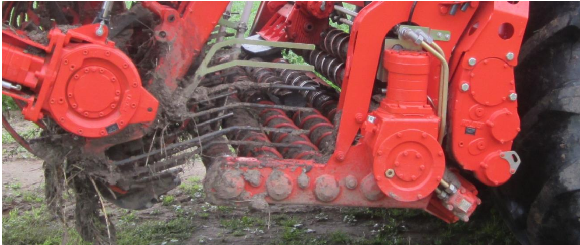
Abbildung 12: Rost mit Wendelwalzen in der Aufnahmevorrichtung eines Rübenvollernters
