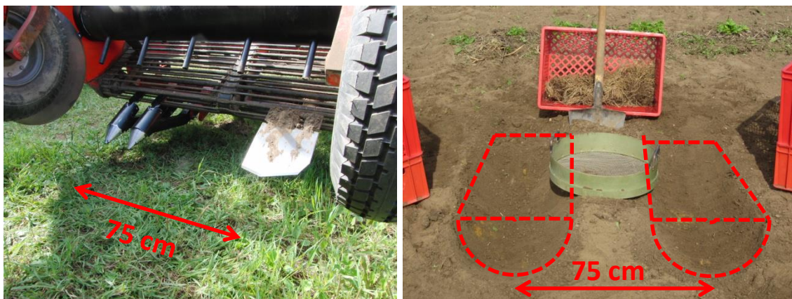
Abbildung 29: 1. Aufnahmevorrichtung mit verschiedenen Schartypen, r. Probenentnahme mit einem runden Handsieb.
