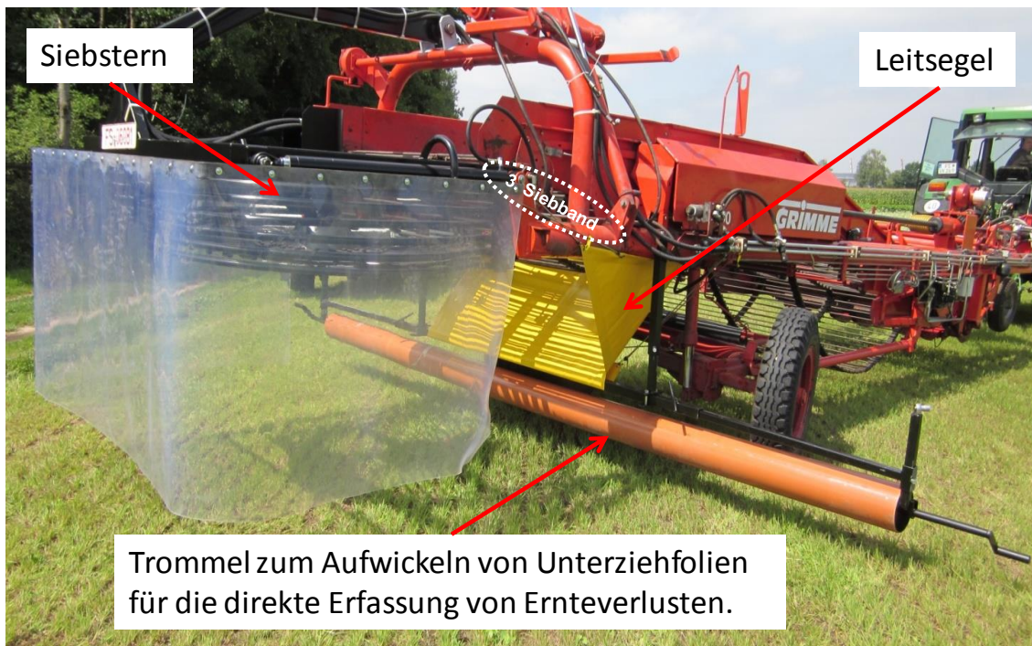
Abbildung 22: Trägerfahrzeug für die Versuchsdurchführung
