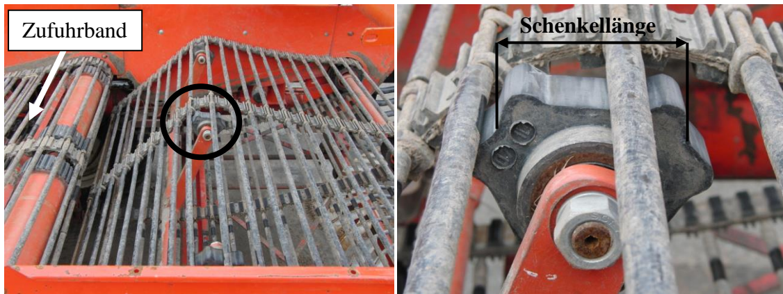
Abbildung 18: Reinigungssystem „Rotation“ (r.) Ausschnitt: Passives Rüttelelement
