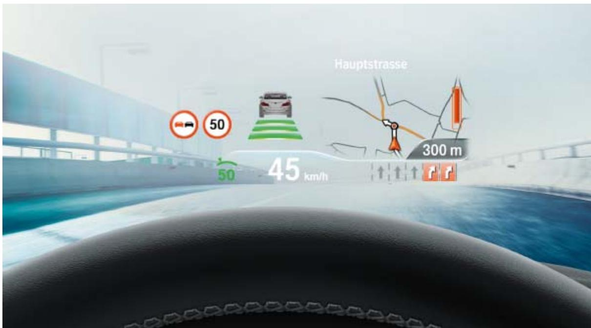
Abbildung 15: Head-Up Display Darstellung im aktuellen BMW 5er Modell von 2017 mit aktiver Navigation und Karte, ACC-System sowie einer Verkehrszeichenerkennung und der Geschwindigkeit<sup>3</sup>
