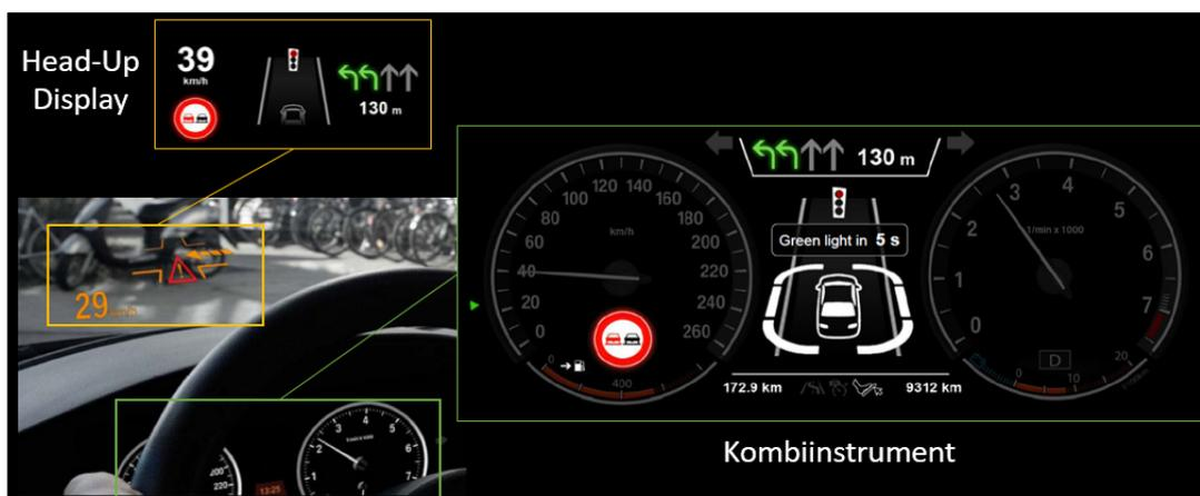
Abbildung 45: Beispielfähige Darstellung in den Komponenten im MMI-Konzept mit geclustertem Head-Up Display (oben) sowie dem Bereich zwischen den Rundinstrumenten im Kombiinstrument (rechts)
