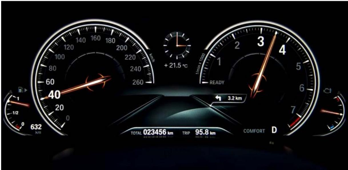
Abbildung 14: Kombiinstrument des BMW 7er G11 von 2015 aus dem Premiumsegment mit freiprogrammierbarer Anzeige und den typischen Rundinstrumenten<sup>2</sup>
