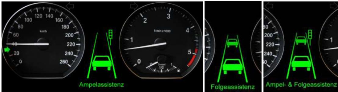
Abbildung 22: Die unterschiedlichen Darstellungen im Kombiinstrument der verschiedenen Systeme. Anzeige des Grüne-Welle-Assistenten (links), Folgeassistenten (Mitte) und beider Systeme gleichzeitig aktiv (rechts) (aus Götze, Ruff, & Bengler, 2015)
