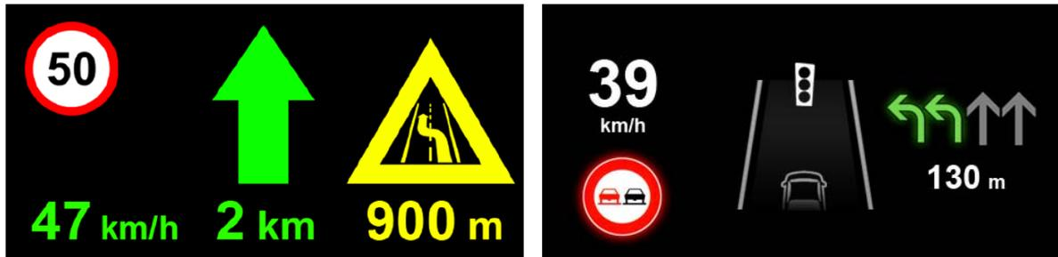
Abbildung 16: Darstellung der Informationen nach dem "Gesetz der Nähe", um zusammengehörige Inhalte gruppiert zu präsentieren. Als Beispiel sind hier eine frühe Version (links) und die finale Version (rechts) des Anzeigekonzepts für das Head-Up Display beispielhaft gewählt.
