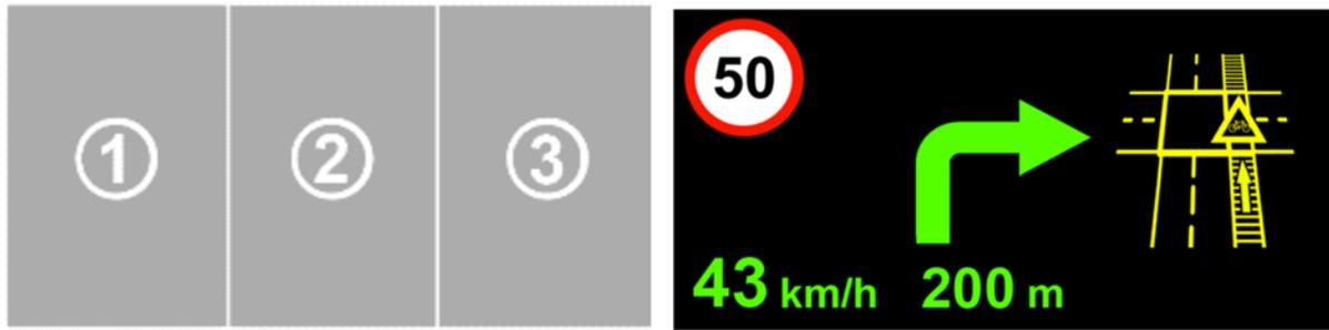
Abbildung 18: Schematische Aufteilung des Head-Up Displays (links) sowie eine beispielhafte Darstellung im Fahrzustand (rechts) (nach Bissbort, 2013)
