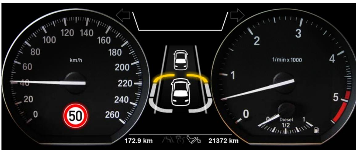
Abbildung 42: Beispielhafte Darstellung des Designs im Kombiinstrument mit aktivem Abstandswarner und der Verkehrszeichenerkennung. Im oberen Bereich des Displays können zusätzlich Navigationsempfehlungen eingeblendet werden.
