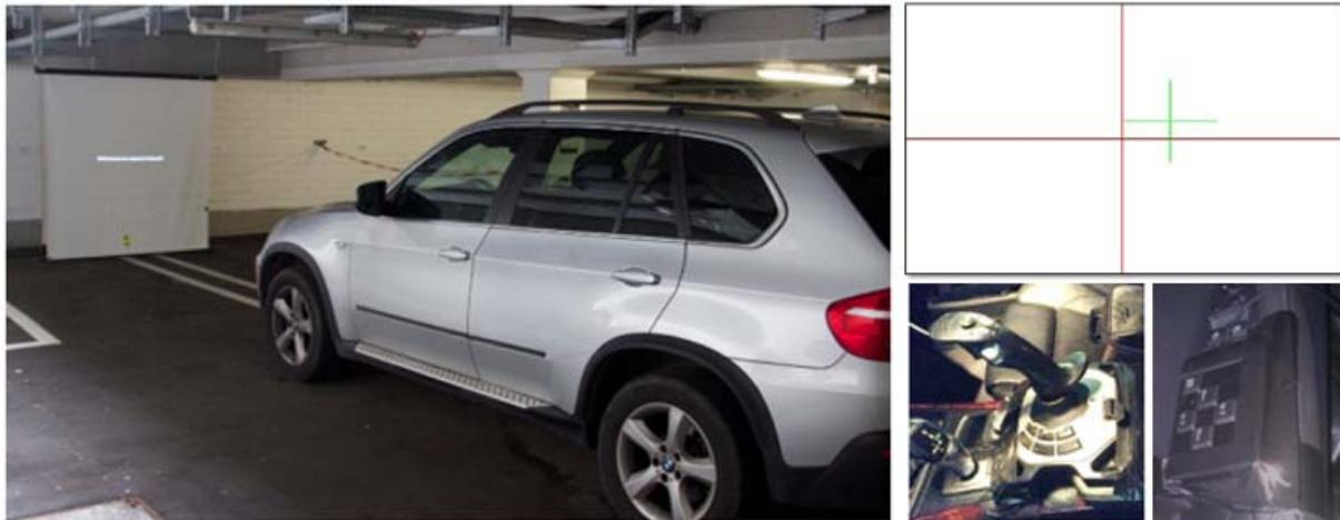
Abbildung 35: Versuchsfahrzeug positioniert vor der Projektionsfläche (links); das Tastenfeld zur Steuerung der CRT auf der Armlehne der Fahrertür (unten rechts) und der Joystick in der Mittelkonsole zur Steuerung der CTT (unten links); beispielhafte Darstellung der CTT (oben)
