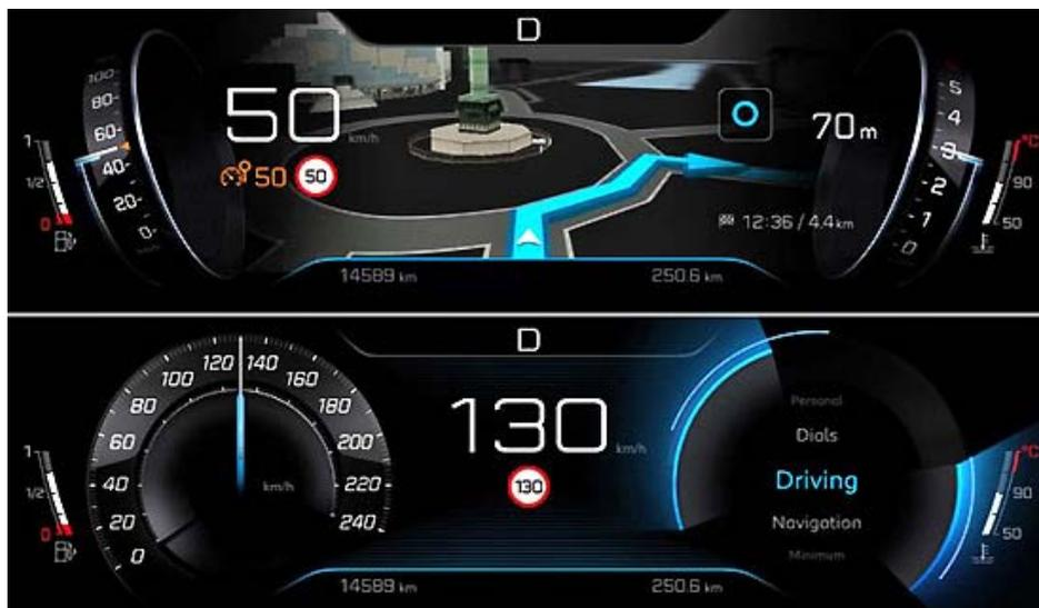
Abbildung 13: Instrument Cluster des SUV Peugeot 3008 von 2016 mit unterschiedlichen MMI-Konzept-Ausführungen und variierenden Anzeigorten gleicher Informationen<sup>1</sup>
