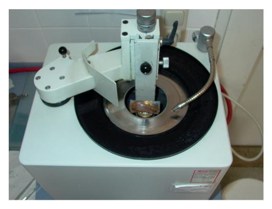
Abbildung 19: Innenlochsäge mit Diamantsägeblatt (Sp1600 der Firma Leica Biosystems)
