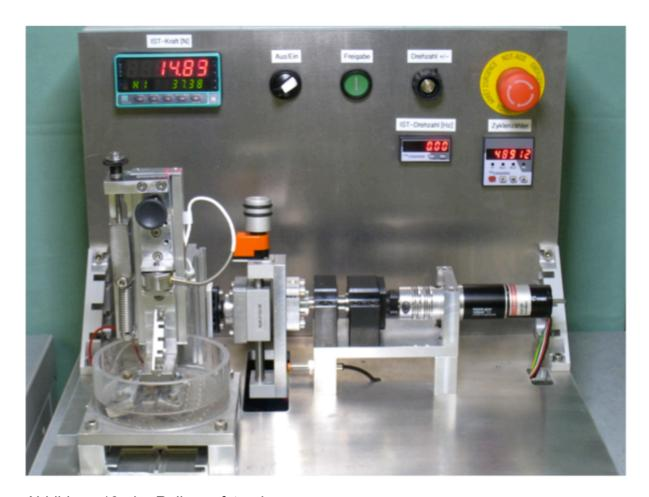
Abbildung 10: der Reibeprüfstand
