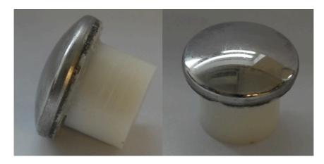
Abbildung 14: Miniprothese, verankert in Plastikzylinder
