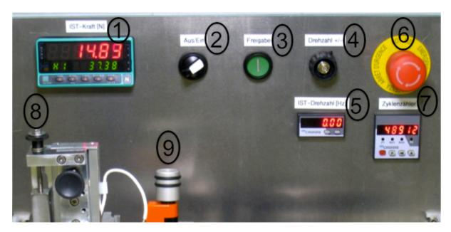
Abbildung 12: Bedienung des Reibeprüfstands; 1) Kraftmessung, 2) Aus/Ein, 3) Start/Stopp, 4) Soll-Drehzahl, 5) Ist-Drehzahl, 6) Not-Aus, 7) Zyklenzähler, 8) Federspannrädchen, 9) Exzentereinstellung
