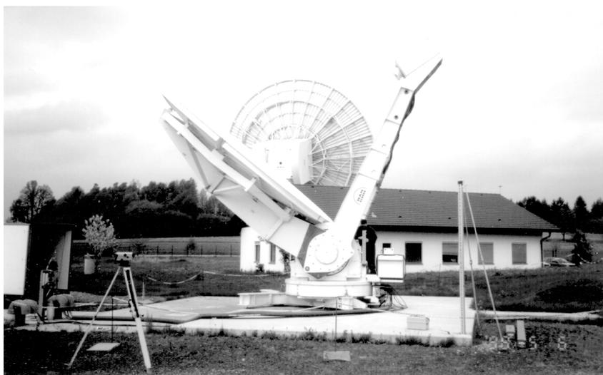
Abb. 4.10: Übertragung des Höhenbezugs zum TIGO-Radioteleskop von exzentrischen Höhenpunkten zu den Höhenbezugspunkten am Radioteleskop durch Nivellement. Mit Zwangszentrierung (Lage) und den drei Ankerschrauben am Radioteleskop (Höhe) kann der räumliche Bezugspunkt bei einer Wiederbesetzung der Plattform erneut hergestellt werden.
