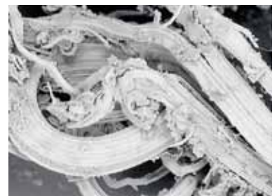
Silberlocken: Korrosionsform von Silber Silver locks: a form of silver corrosion
