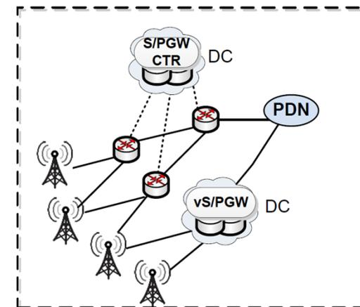
(d) Mixed SDN and NFV Core GW Architecture
