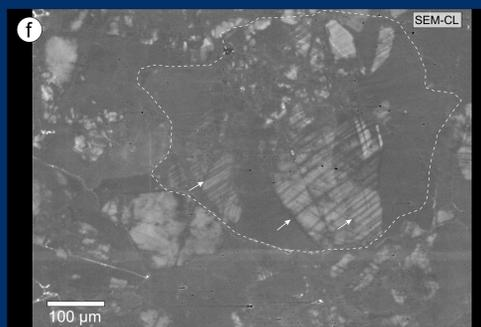
Quarzkörner sind von vielen Bahnen mit Fluideinschlüssen durchzogen (c, e). Im SEM-CL Bild wird die durchgreifende Fragmentierung (b) und der Fluideinfluss auf die Quarzkörner sichtbar (d). Die Ausbildung von Deformationslamellen (Pfeile in e, f) zeigt hierbei eine kristallplastische Deformation (ca. 250-300 °C) unter hohen deviatorischen Spannungen an.
