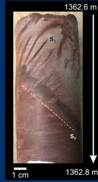
Grundgebirgsprobe mit der charakteristischen steilen Primärschichtung (s<sub>0</sub>) und der Ausbildung einer Schieferung (s<sub>1</sub>)
