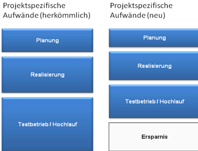
Abbildung 1.1: Vergleich der projektspezifischen Aufwände für Planung, Realisierung und Test bei Materialflussanlagen mit zentraler Steuerung (l.) und dezentral gesteuerten Anlagen (r.) ([Kuz10], S.9)
