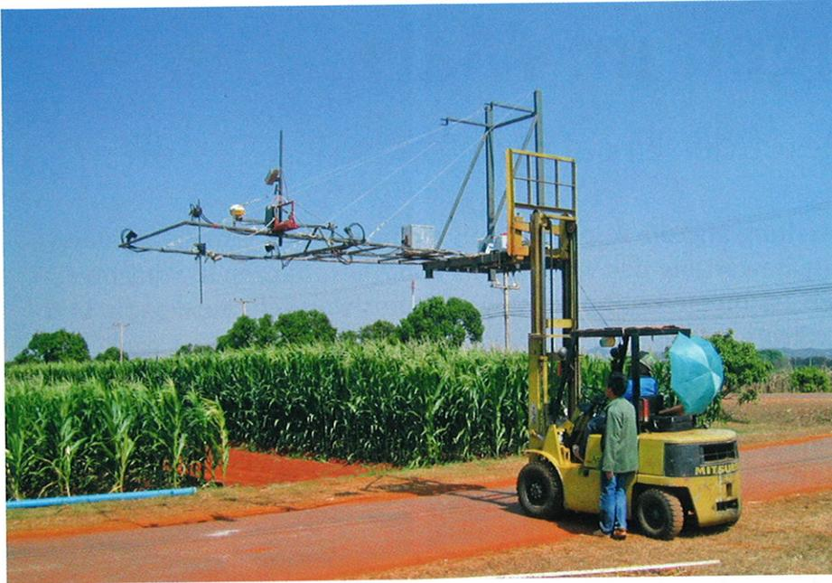
Abb. 2: Sensorsystem und Trägerfahrzeug auf der Versuchsstation des National Corn and Sorghum Center in Thailand
