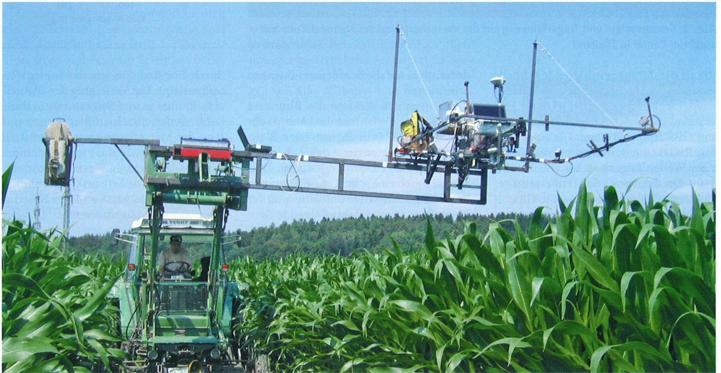
Abb. 1: Sensorsystem und Trägerfahrzeug zur Erfassung von Eigenschaften von Maispflanzen in Beständen. Versuchsstation Dürnast des Lehrstuhls für Pflanzenernährung der Technischen Universität München
