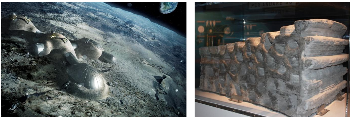
Abb. 2: Kuppelbehausungen auf dem Mond nach Vorstellungen des Architekturbüros Foster+Partners ( links ) sowie ein 1,5 Tonnen schwerer, 3D-gedruckter Baustein-Prototyp ( rechts ) [5].
