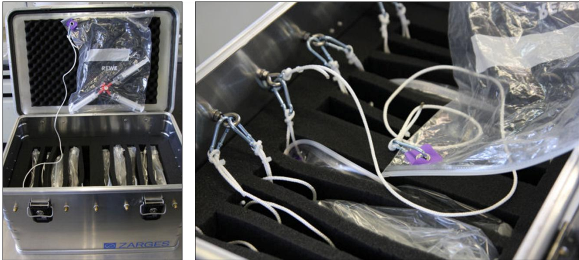
Abb. 45: Zarges-Box befüllt mit zehn Versuchsproben, wasserdicht verpackt in PE-Beuteln, die über eine Schnur mit Karabinerhaken und Ösen an der Aluminiumbox befestigt werden.
