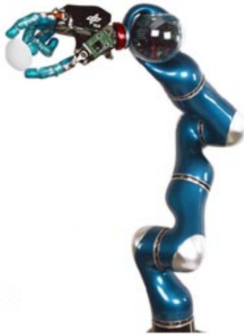
Abbildung 4.1.: Der Ballfang-Roboter vom Typ LBR III [14]
