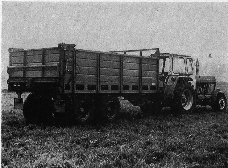
Hydraulisch betätigte Rückwand am Spezialanhänger HTS 90.04/T 088
