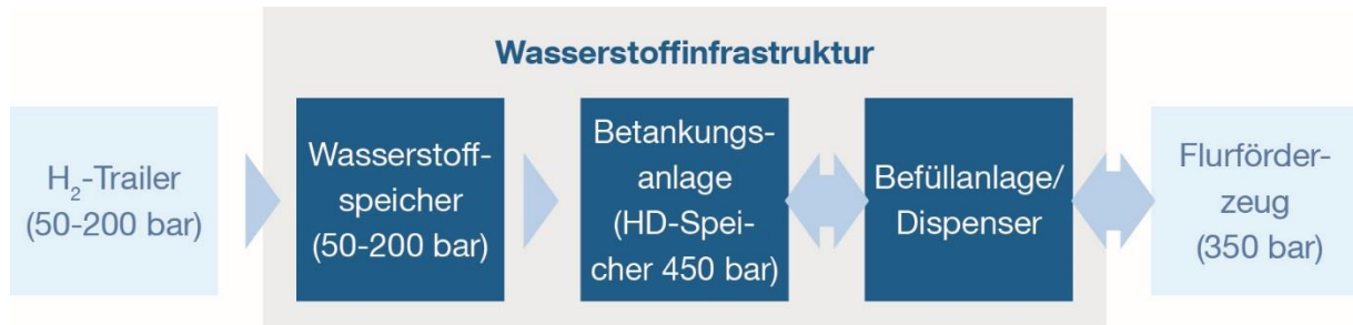
Abbildung 2: Schematische Darstellung der Wasserstoffversorgung im Projekt H2IntraDrive
