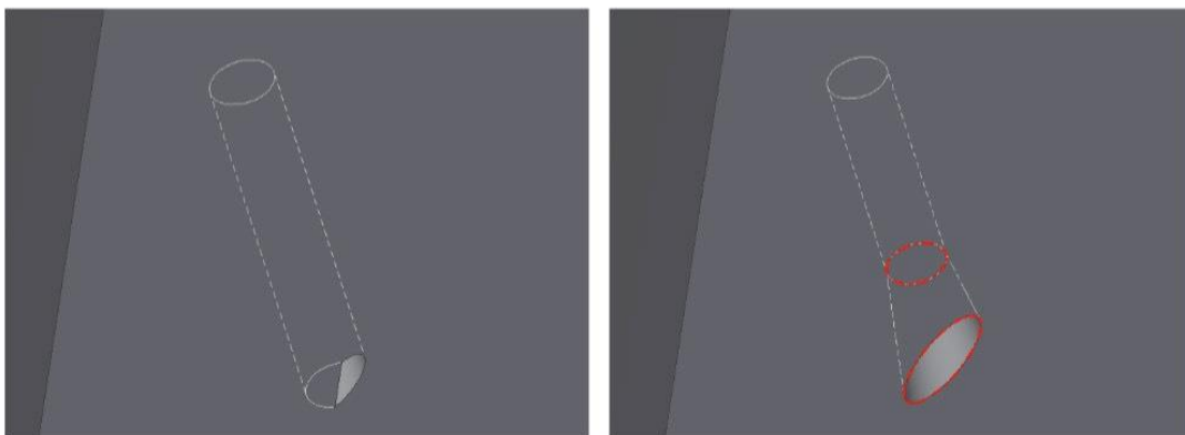
Abb. 2.1 – 2.2 Bohrung für Dübel
