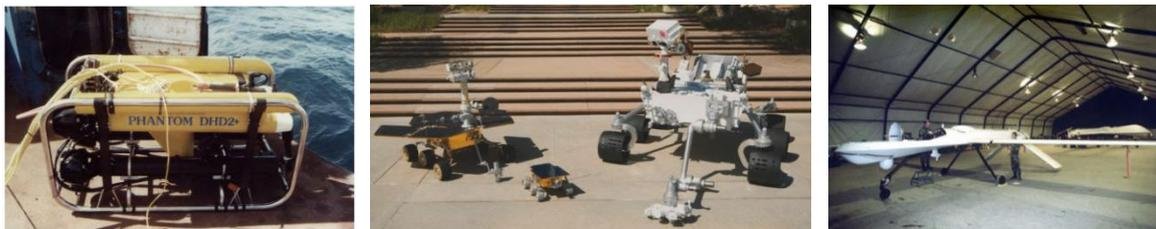
Abbildung 2.1: Unterschiedliche teleoperierte Roboter: Links ein Remotely Operated Vehicle (ROV) für Tiefseearbeiten [Fon01a, S. 128], in der Mitte die Mars Exploration Rover der NASA [Baj08], rechts ein unbemanntes Erkundungsflugzeug der US Air Force vom Typ Predator [Fon01a, S. 124].
