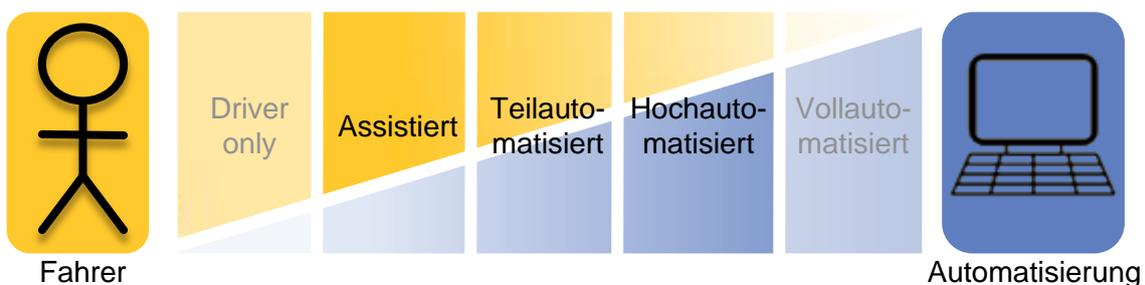
Abbildung 4.1: Einteilung der Automatisierungsstufen nach Definition der BASt-Projektgruppe „Rechtsfolgen zunehmender Fahrzeugautomatisierung“ (eigene Darstellung nach [Fle11]).
