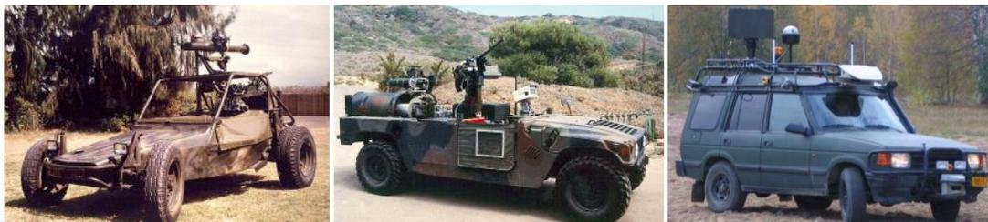
Abbildung 2.2: Unbemannte Bodenfahrzeuge: Die Bilder zeigen einen Dune Buggy (links) und einen HMMWV (mittig) aus den 1980ern, die vom Naval Ocean Systems Center mit Hilfe eines fiberoptischen Kabels teleoperiert wurden [Fon01a, S. 126]. Rechts ist ein Land Rover Discovery des Finnischen Militärs dargestellt, der zur Fernsteuerung per Wireless LAN umgebaut wurde [App10, S. 238].
