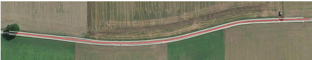
Abbildung 6.2: Das teleoperierte Fahren wurde auf der dargestellten Teststrecke validiert. In rot ist dabei der exemplarische Verlauf des Fahrzeugschwerpunkts bei einer Testfahrt dargestellt. Die detektierten Fahrbahnränder sind in weiß dargestellt (Satellitenbild: Google Earth).
