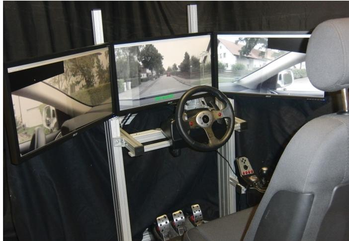
Abbildung 2.5: Operatorarbeitsplatz zur Fahrzeugteleoperation.
