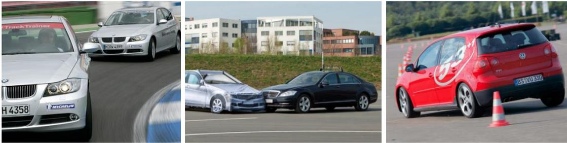
Abbildung 3.2: Konzepte zum hochautomatisierten Fahren: links abgebildet der *BMW Track Trainer* zum Erlernen einer Sicherheitslinie auf der Rennstrecke [BMW11]; mittig die Darstellung einer automatischen Kollision mit einem Softtarget auf dem Testgelände von Daimler [Sch11]; rechts automatisches Fahren mittels Optimalsteuerung durch Pylontore im Volkswagen-Projekt *GTI 53+1* [Mül06].
