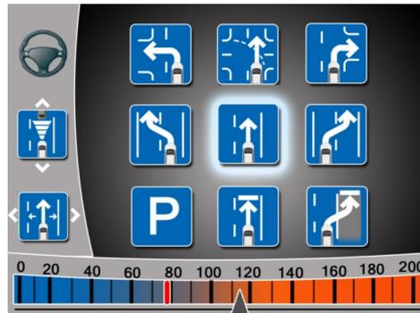
Abbildung 3.11: Benutzerschnittstelle zum manöverbasierten Fahren im Rahmen des Conduct-by-Wire [Kau10].
