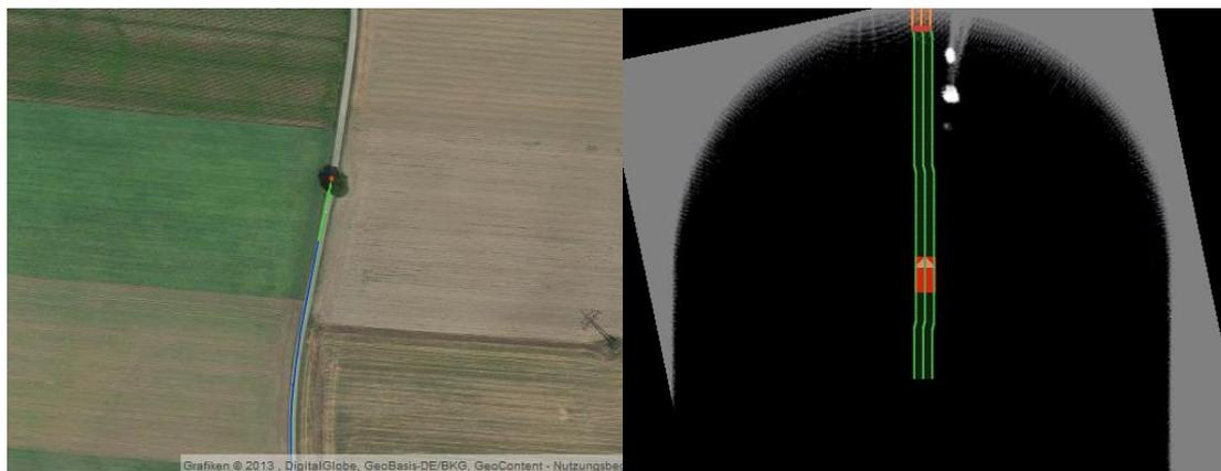
Abbildung 5.10: Neben dem Kamerabild werden dem Operator eine Kartenansicht sowie eine Lidar-belegungskarte der aktuellen Situation dargestellt. Der Pfad wird jeweils perspektivisch überlagert.
