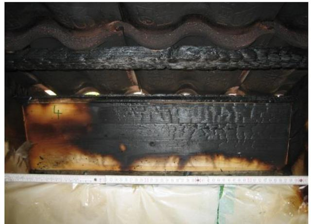
Abbildung 16: Traufanschluss DA1 ⊥ AW2 auf der Innenseite vor und nach dem ersten Brandversuch
