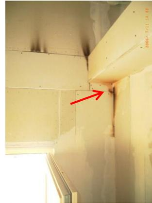
Abbildung 15: Brandbeanspruchung nach 25 Minuten Branddauer und Brandweiterleitung über Fuge entlang des Rähms der Außenwand in angrenzenden Raum (Flur)
