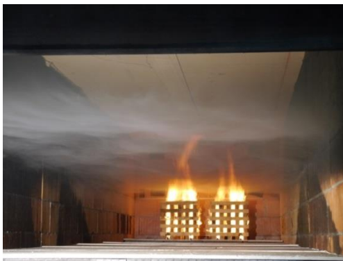
Abb. 4: Großbrandversuch: Prüfung eines vorelementierten Prüfkörpers nach DIN 18234-1
