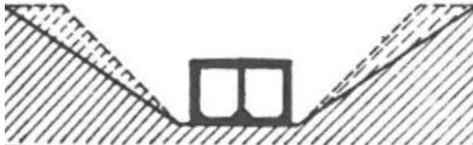
Abbildung 2-2 Baugrube mit Böschung<sup>8</sup>
