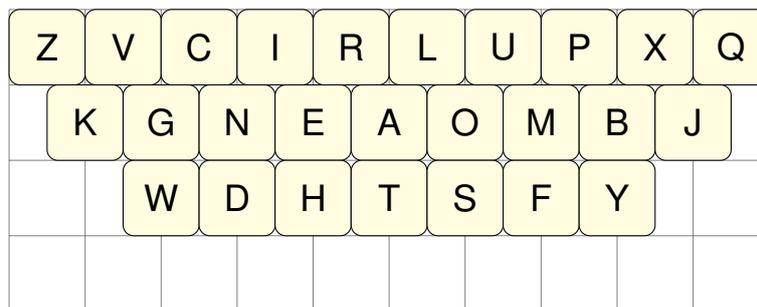
**Abbildung 60:** [Lesher u. Moulton, 2000]-Tastenbelegung für das QWERTY-like-Layout
