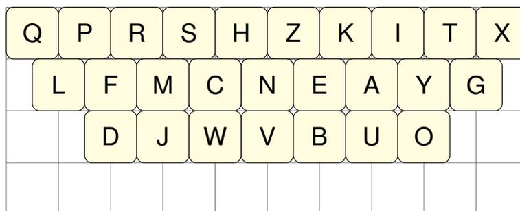
**Abbildung 61:** [Light u. Anderson, 1993]-Tastenbelegung für das QWERTY-like-Layout
