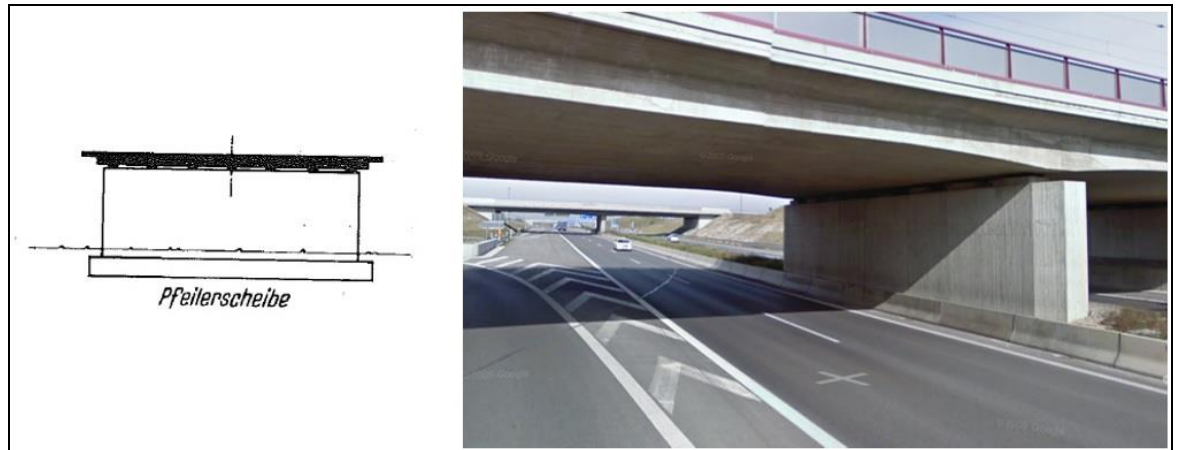
Abbildung 23: System der Pfeilerscheibe (links) [14] und eine Autobahnunterführung [20]
