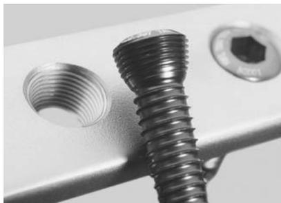
**Abb. 16: Kopfverriegelungsschraube des LISS-Systems.** In dieser Abbildung ist das winkelstabile Kopfverriegelungssystem des LISS zu sehen, welches durch ein ineinandergreifendes Gewinde von Plattenloch und Schraubenkopf erreicht wird (Operationsanleitung, Fa. Synthes GmbH).
