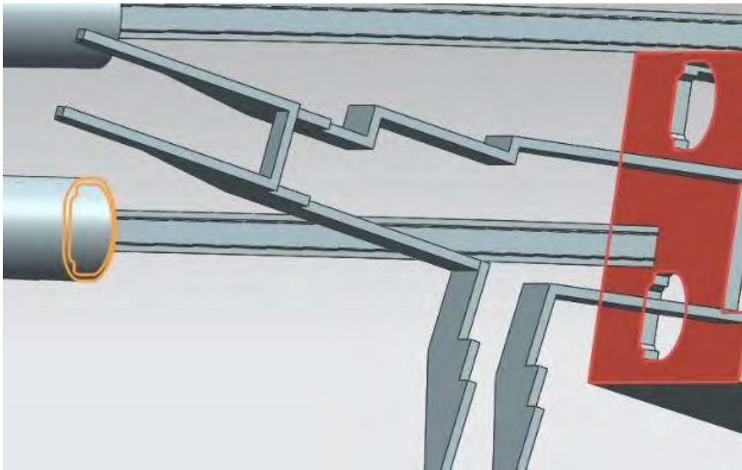
Abbildung 3.13: Positionierung nach der Zwangsbedingung „Berührung“
