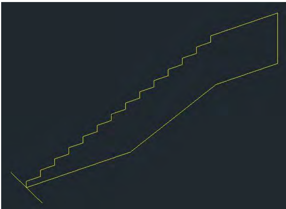
Abbildung 3.4: Reduktion auf Skizze und Extrusionsführung
