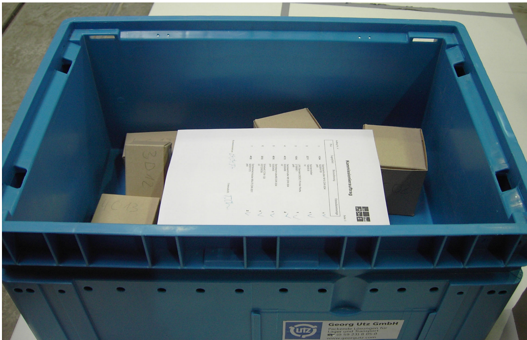
Abbildung 3-14: Abgelegte Kommissionierliste im Sammelbehälter nach Abschluss des Auftrags
