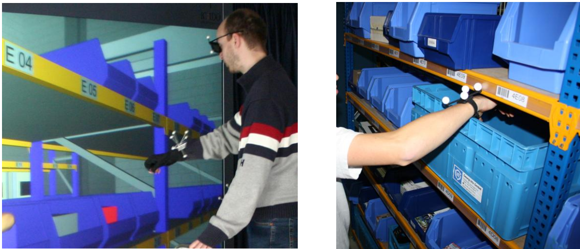
Abbildung 5-11: Target am Handgelenk des Nutzers zur Interaktion in einer VR-Umgebung (links) und in der AR-unterstützten Kommissionierung (rechts)
