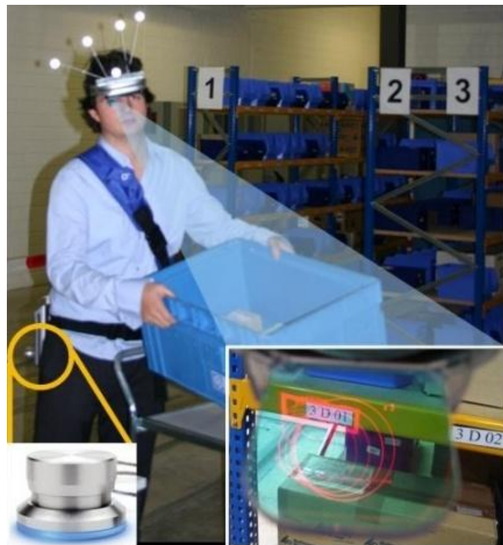
Abbildung 2-4: Pick-by-Vision System (Bildquelle: Lehrstuhl für Fördertechnik Materialfluss Logistik, Technische Universität München)
