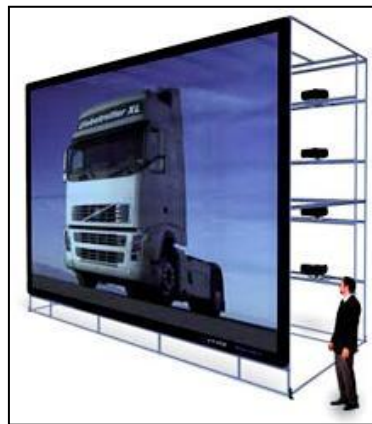
Abbildung 6-2: Aufbau einer Powerwall [Dim-10]
