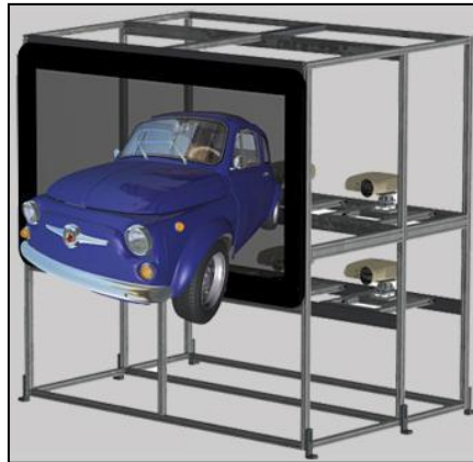
Abbildung 6-6: Schematischer Aufbau eines VR-Centers [Dim-10]
