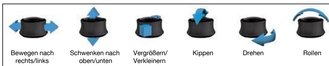
Abbildung 5-3: Bewegungsfunktionen einer 3D-Maus [Con-09]
