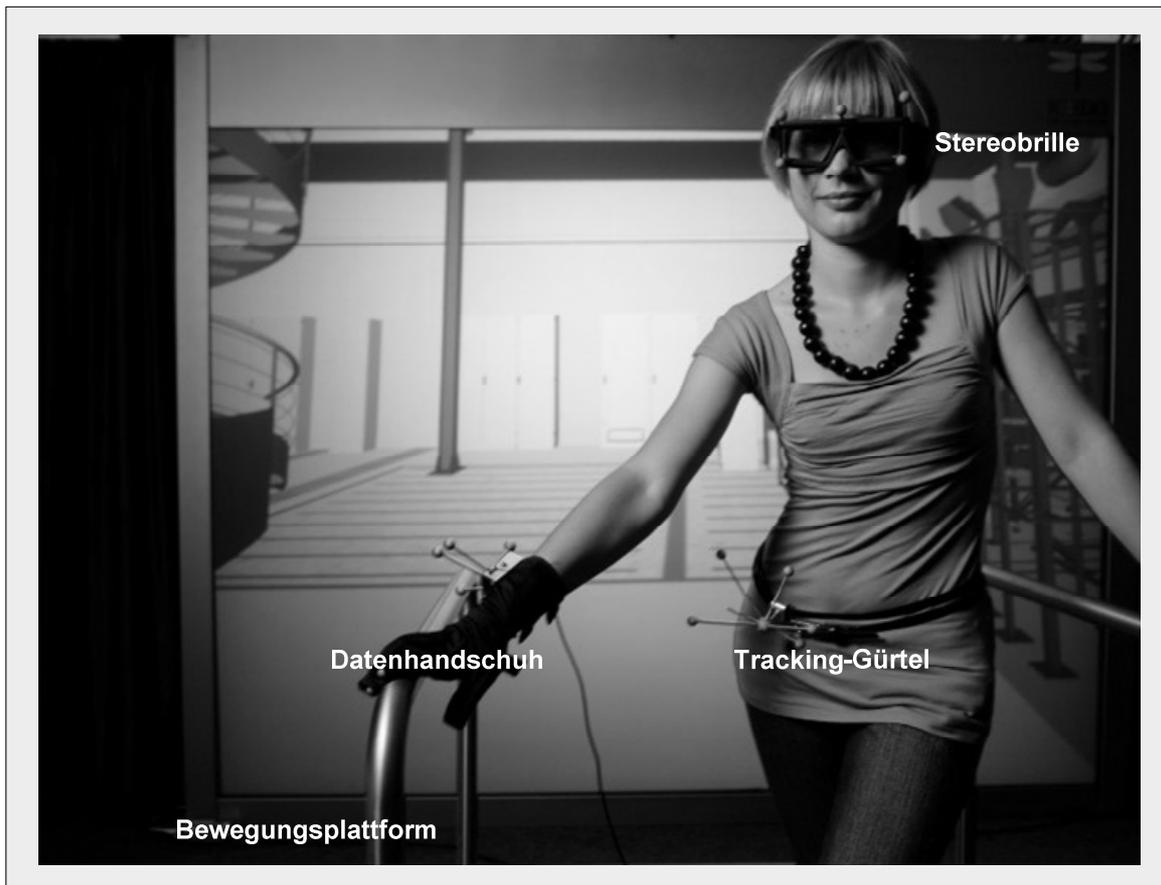
**Abbildung 6-6: Interaktionsgeräte der Simulationsplattform**
