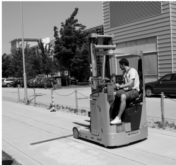
Abbildung 10: Schwellenüberfahrt und Sprunganregung auf der Teststrecke des Lehrstuhls fml mit einem Schubmast- und einem Gegengewichtsgabelstapler
