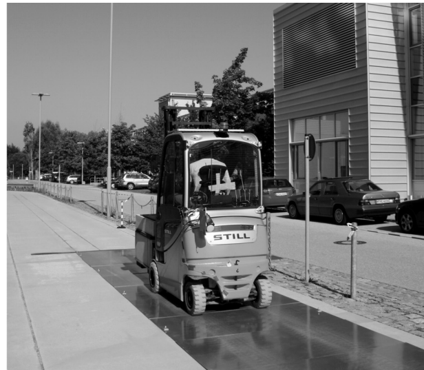
Abbildung 10: Schwellenüberfahrt und Sprunganregung auf der Teststrecke des Lehrstuhls fml mit einem Schubmast- und einem Gegengewichtsgabelstapler
