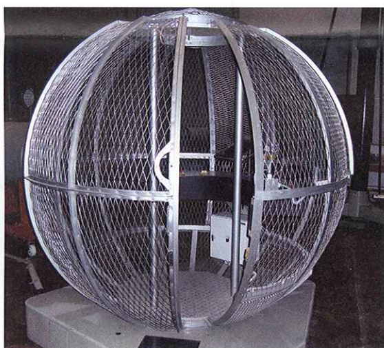
05 Die Faradaykugel mit 2,5 m Durchmesser ist mit Sicherheitssensoren, Not-Aus-Taster und magnetischer Zuhaltung ausgerüstet
