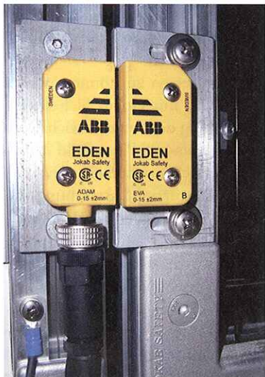
03 Der Steuerstand ist mit einem Schutzzaun Quick-Guard, einem Sensorpaar Eden, einem Not-Aus-Taster Smile und einer magnetischen Zuhaltung Magne geschützt
